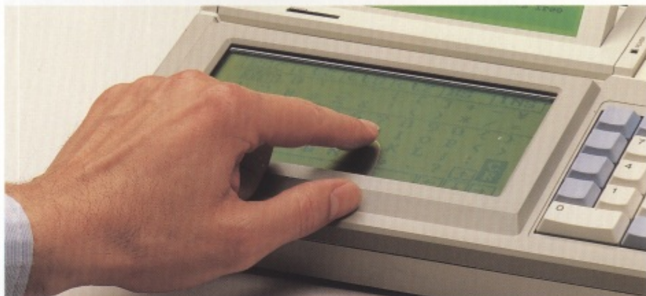
Touch Keyboard. Ein großflächiges LCD, das Anzeige- und Bedienungselement in einem ist.
